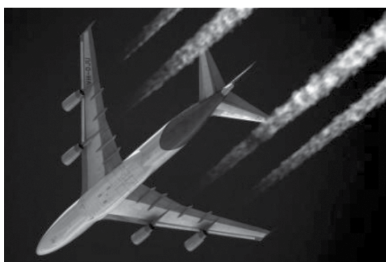
▲ شکل ۱ دنباله ابری تشکیل شده در پشت آگروز یک بوئینگ ۷۴۷ در ارتفاع ۱۱۰۰۰ متری
